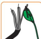
Attention ! Respecter la position des pinces ! La pince crocodile verte doit uniquement être raccordée au câble de mise à la terre (non isolé) !
