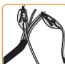
Atenção! Os cabos de prova de cor negra com pinças de crocodilo devem-se conectar aos fios com isolamento (círcuito cabo de aquecimento).
