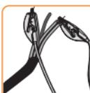
Bemærk! Vær opmærksom på klemning! Sorte krokodilleklemmer skal udelukkende klemmes på isolerede varmekabler (frem- og tilbageleder)!
