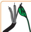
Bemærk! Vær opmærksom på klemning! Grøn krokodilleklemme må kun klemmes til afskærmningskablet (uisoleret)!
